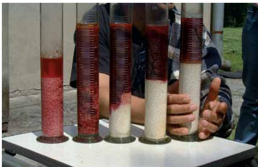
Prezentacja wodoodporności mieszaniny saletrolu z guar gum w różnej proporcji w Centralnym Laboratorium Techniki Strzelniczej i Materiałów Wybuchowych
